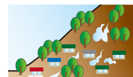
③斜面から水が噴き出す
